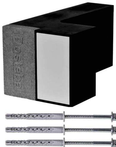
Elementi di fissaggio in poliuretano ad alta densità con armatura in acciaio, alluminio e resina fenolica per il fissaggio nei sistemi ETICS di carichi senza formazione di ponte termico in imbotte finestra.
